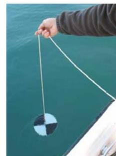
La mesure de transparence de l'eau à l'aide du disque de Secchi.
